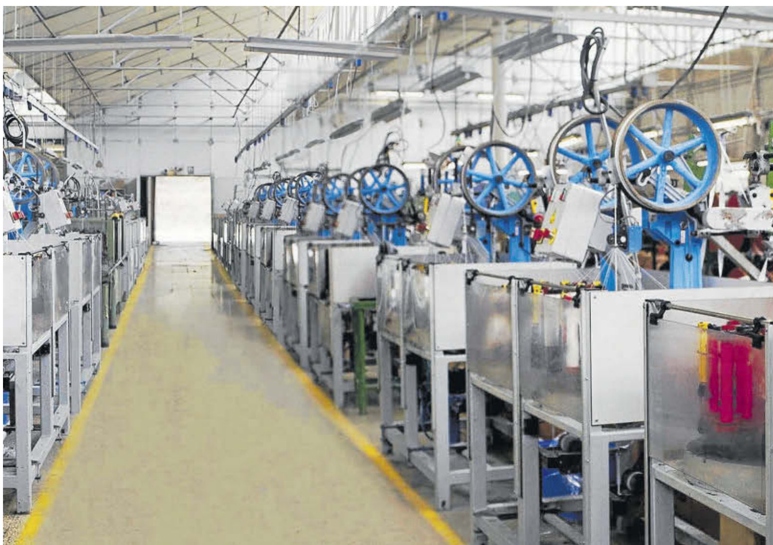
Líneas de producción de Liasa, en La Selva del Camp, modificadas para fabricar gomas elásticas para mascarillas. FOTO: CEDIDA
